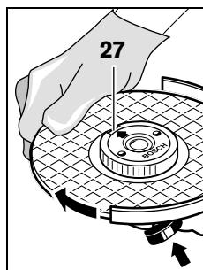
Для фиксирования шлифовального шпинделя нажмите кнопку фиксирования шпинделя 1. Для затягивания быстроажимной гайки поверните шлифовальный круг с усилием по часовой стрелке.
