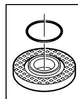
На опорном фланце 7 вокруг центрирующего буртика находится пластмассовая деталь (кольцо круглого сечения). Если кольцо круглого сечения отсутствует или повреждено, опорный фланец 7 необходимо обязательно заменить перед дальнейшим применением.
