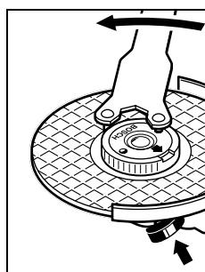
Правильно закрепленную, не имеющую повреждений быстроажимную гайку Вы можете отвернуть, вращая рукой кольцо с накаткой против часовой стрелки. **Никогда не отворачивайте прочно сидящую быстроажимную гайку клеммами, а пользуйтесь ключом для гаек с двумя торцевыми отверстиями.** Накладывайте ключ для гаек с двумя торцевыми отверстиями согласно рисунку.
