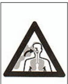
**Внимание!** При работающем двигателе мотоагрегата выделяются ядовитые газы. Эти газы могут быть без запаха и невидимыми. Никогда не работайте мотоагрегатом в закрытых или плохо проветриваемых помещениях!
