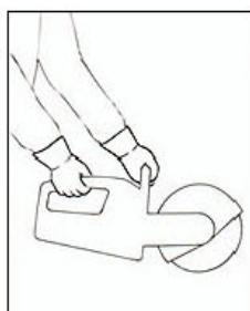
**Мотоагрегат удерживатьочно обеими!** Правая рука находится на задней ручке – только так обеспечивается надежное ведение устройства – это действительно также для левши. Ручку и трубчатую рукоятку охватить плотно большим пальцем. При работе занять прочное и устойчивое положение!
