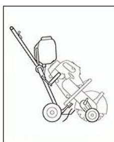
Аbrasivno-отрезное устройство NS 400 может монтироваться на направляющей тележке фирмы STIHL всего лишь за несколько приемов. Направляющая тележка упрощает обращение с агрегатом и является необходимым вспомогательным средством при:
