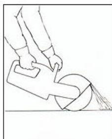
Установить правильно защитный кожух шлифовального круга: снимаемые частицы материала должны отводиться от пользователя и устройства.
